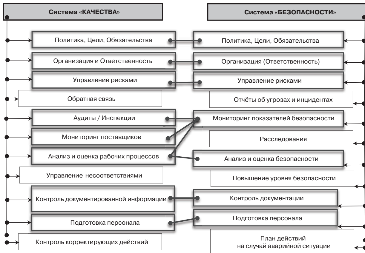
Рис. 1. Общие и специфичные принципы систем: системы менеджмента качества (QMS) и системы управления безопасностью (SMS)
